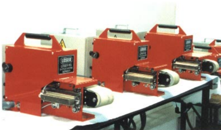
SF 104 Modelle in Ausführung 100, 75 und 50 mm Filmbreite SF 104 model as 100, 75 and 50 mm film width
